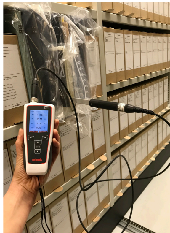
LUFTFUKTIGHET SJEKKES: Kontroll av arkivmateriale for å avdekke muggsopp inngår også i IPM-programmet ved IKA Østfold. Muggsoppkadede arkiv isoleres i påvente av rensing ved saneringsavdelingen. Her måles luftfuktigheten inne i arkivstykker som er isolert for å unngå ny oppvekst.
